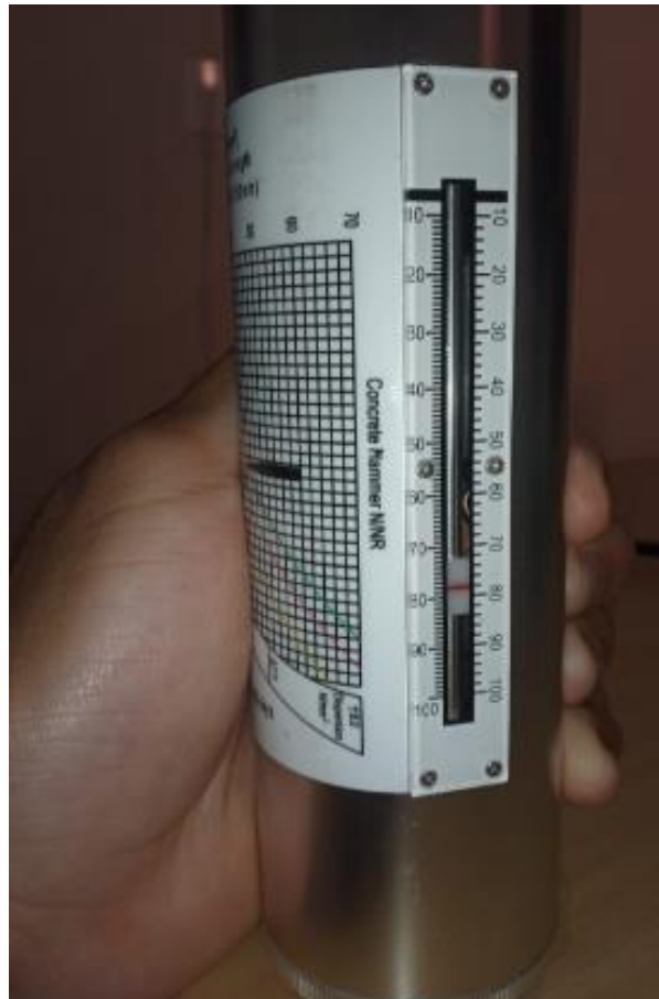
Figura 36- Aferição do esclerômetro
