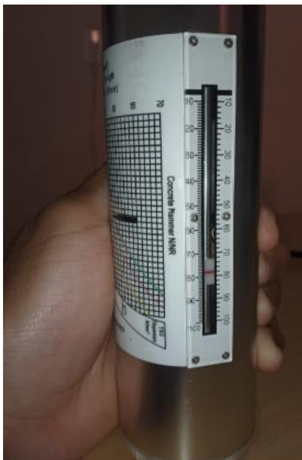
Figura 36- Aferição do esclerômetro
