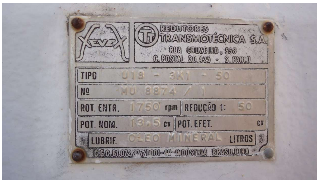
Foto 7. Plaqueta de identificação do modelo dos redutores existentes.
