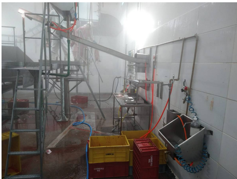
5. Conjunto de plataformas da sala de abate (7 unidades) completas com pias de assepsia, esterilizadores de facas. Estado de conservação: Regular
