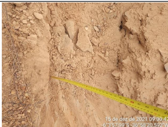
FOTO 01 – Sítio da ETA Jucurutu. Material de 1ª categoria. Solo argilo-arenoso, marrom claro, com fragmentos de rocha, e rocha alterada dura na base. Espessura = 0,90 m. Impenetrável aos 0,90 m.
