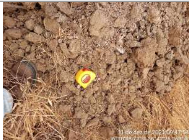
FOTO 16 – Material de 1ª categoria. Solo argil-arenoso, marrom, com torrões e cascalho. Espessura = 0,30 m.
