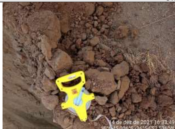
FOTO 32 – Material de 1ª categoria. Solo argiloso a argilo-siltoso, vermelho, com torrões. Espessura = 0,95 m.
