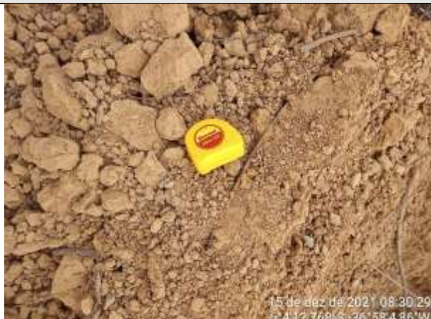
FOTO 42 – Material de 1ª categoria. Solo argiloso a argilo-siltoso, marrom claro, com torrões. Espessura = 0,60 m.
