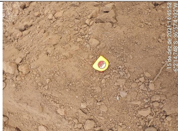
FOTO 18 – Material de 1ª categoria. Solo areno-argiloso, marrom claro, com torrões. Espessura = 1,10 m.
