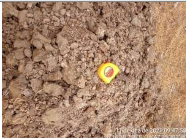
FOTO 17 – Material de 2ª categoria. Solo de alteração argilo-arenoso, marrom acinzentado, com fragmentos de rocha. Espessura = 0,20 m. Impenetrável aos 0,50 m.
