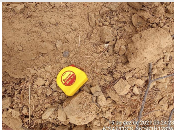
FOTO 02 – Material de 1ª categoria. Solo areno-argiloso, marrom, com torrões e pouco cascalhoso. Espessura = 0,35 m.
