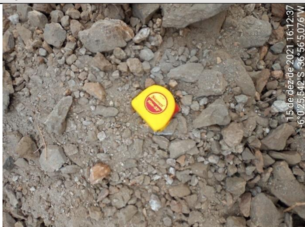
FOTO 30 – Material de 2ª categoria. Solo de alteração areno-argiloso, marrom, com fragmentos de rocha e rocha alterada mole na base. Espessura = 0,40 m. Impenetrável aos 1,05 m.
