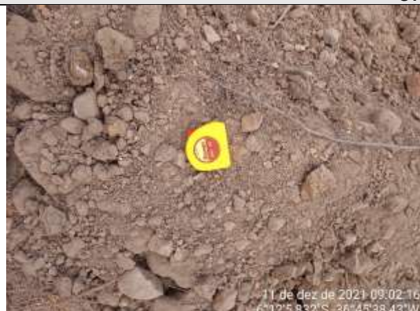
FOTO 12 – Material de 1ª categoria. Solo argilo-arenoso, marrom, com cascalho. Espessura = 0,42 m.
