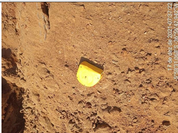
FOTO 45 – Material de 2ª categoria. Solo de alteração areno-argiloso, marrom, com fragmentos de rocha e rocha alterada mole na base. Espessura = 0,38 m. Impenetrável aos 1,20 m.
