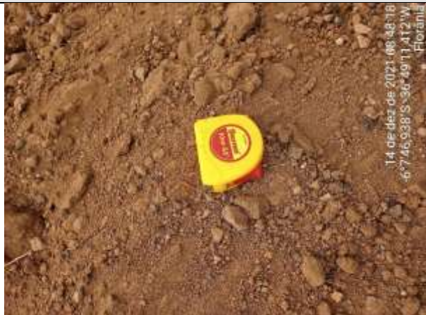
FOTO 24 – Material de 1ª categoria. Solo areno-argiloso, marrom avermelhado, cascalhoso. Espessura = 0,35 m.
