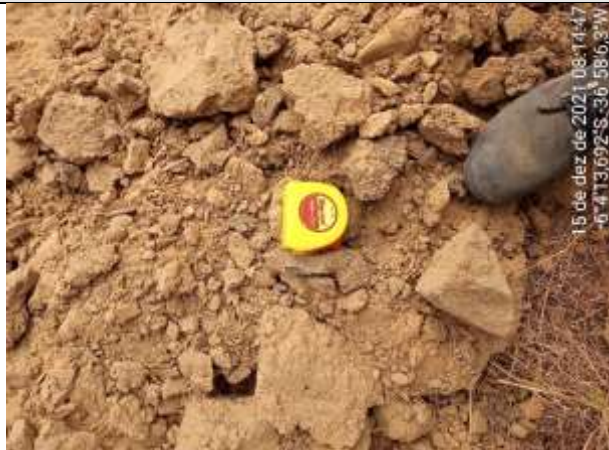
FOTO 40 – Material de 1ª categoria. Solo argiloso a argilo-siltoso, marrom claro, com torrões. Espessura = 0,40 m.
