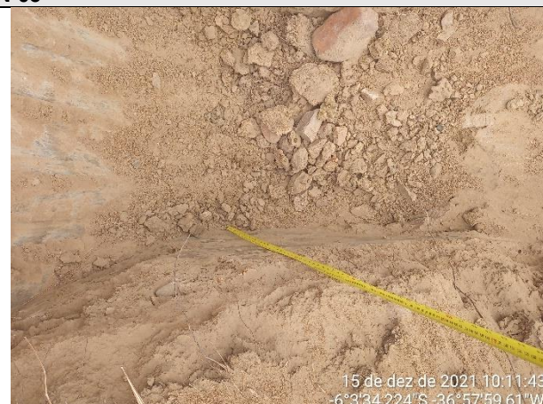
FOTO 07 – Material de 2ª categoria. Solo de alteração arenoso, pouco argiloso, marrom, com rocha alterada mole na base. Espessura = 0,35 m. Impenetrável aos 0,90 m.
