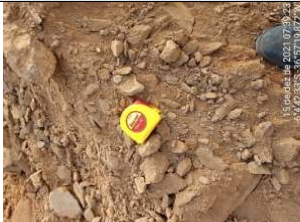
FOTO 39 – Material de 2ª categoria. Solo de alteração argilo-arenoso, marrom claro, com fragmentos de rocha e rocha alterada dura na base. Espessura = 0,48 m. Impenetrável aos 1,20 m.
