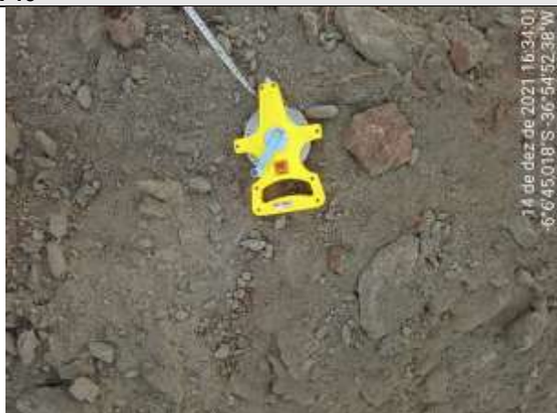
FOTO 33 – Material de 2ª categoria. Solo de alteração argilo-arenoso, marrom acinzentado, com fragmentos de rocha. Espessura = 0,65 m. Impenetrável aos 1,60 m.
