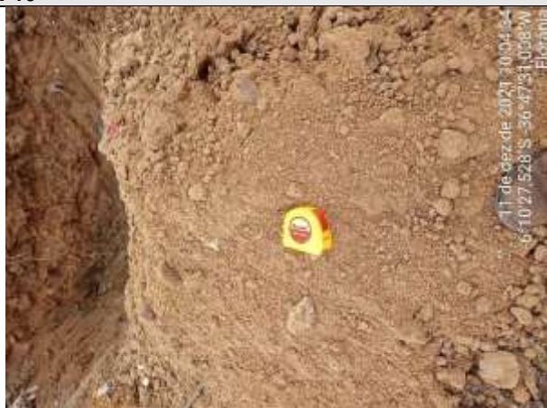
FOTO 19 – Material de 2ª categoria. Solo de alteração argilo-arenoso, marrom com fragmentos de rocha. Espessura = 0,82 m. Impenetrável aos 1,40 m.
