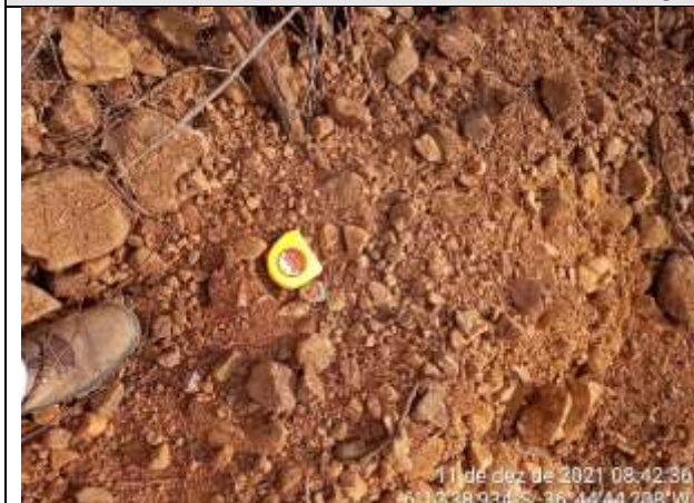
FOTO 10 – Material de 1ª categoria. Solo argilo-arenoso, vermelho, com cascalho e seixo. Espessura = 0,30 m.
