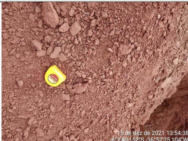
FOTO 15 – Material de 2ª categoria. Solo areno-argiloso, vermelho, com fragmentos de rocha e rocha alterada mole. Atingiu 2,00 m de profundidade antes de alcançar o impenetrável, paralisando a esta profundidade.
