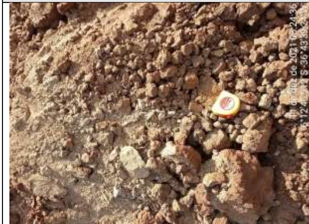
FOTO 08 – Material de 1ª categoria. Solo argiloso a argilo-siltoso, vermelho, com torrões e fragmentos de rocha. Espessura = 0,60 m.
