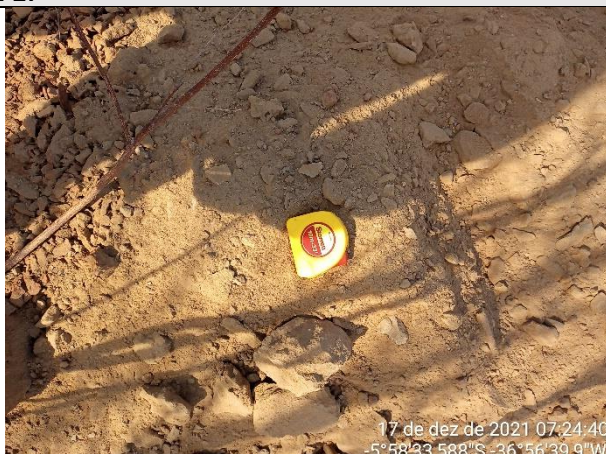
FOTO 43 – Material de 2ª categoria. Solo de alteração areno-argiloso, marrom, com fragmentos de rocha e rocha alterada mole. Atingiu 2,00 m de profundidade antes de alcançar o impenetrável, paralisando a esta profundidade.
