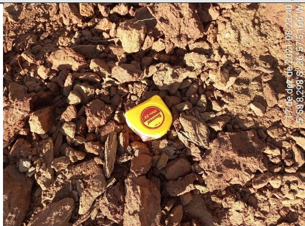
FOTO 48 – Material de 1ª categoria. Solo areno-argiloso, vermelho, com torrões. Espessura = 0,90 m.
