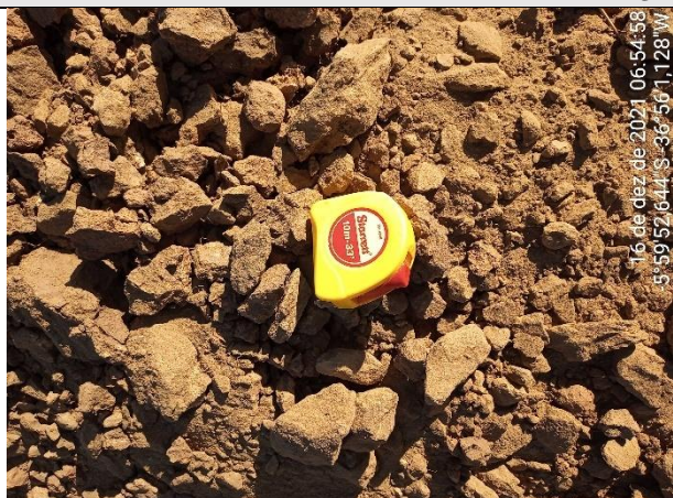
FOTO 33 – Material de 1ª categoria. Solo areno-argiloso, marrom, com fragmentos de rocha. Espessura = 1,40 m.
