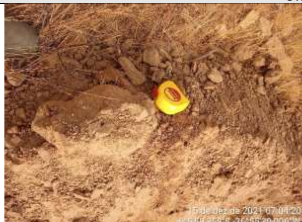
FOTO 34 – Material de 1ª categoria. Solo argiloso a argilo-siltoso, vermelho, com torrões. Espessura = 1,20 m.
