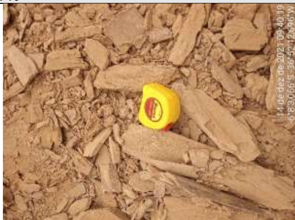
FOTO 29 – Material de 2ª categoria. Solo de alteração areno-argiloso, marrom com fragmentos de rocha e rocha alterada mole na base. Espessura = 0,20 m. Impenetrável aos 0,60 m.
