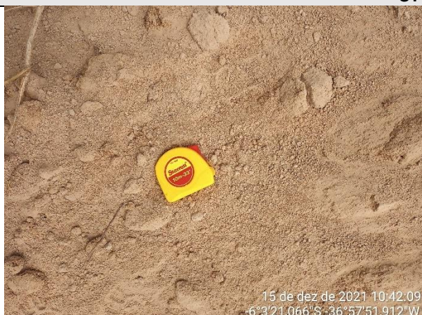
FOTO 08 – Material de 1ª categoria. Solo arenoso, pouco siltoso, amarelo. Espessura = 1,10 m.
