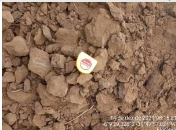
FOTO 20 – Material de 1ª categoria. Solo argiloso a argilo-siltoso, marrom, com torrões. Espessura = 0,90 m.
