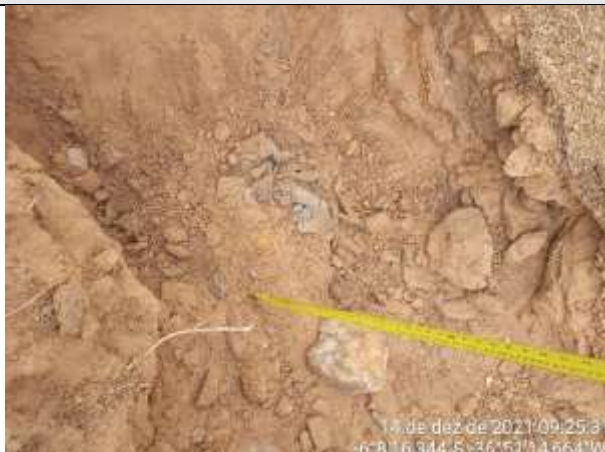
FOTO 27 – Material de 1ª categoria. Solo areno-siltoso, marrom claro, com fragmentos de rocha, e rocha alterada dura na base. Espessura = 0,80 m. Impenetrável aos 0,80 m. OBS.: Afloramento de 100 m metros antes da locação do ponto.
