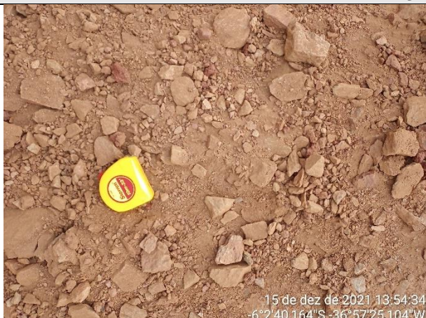
FOTO 14 – Material de 1ª categoria. Solo areno-argiloso, marrom, com fragmentos de rocha. Espessura = 1,40 m.
