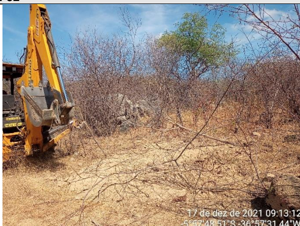
FOTO 51 – Material de 1ª categoria. Solo areno-argiloso, pouco siltoso, marrom amarelado, com fragmentos de rocha e rocha alterada mole na base. Espessura = 0,90 m. Impenetrável aos 0,90 m. OBS.: Em um raio de 50 metros existem diversos afloramentos rochosos.
