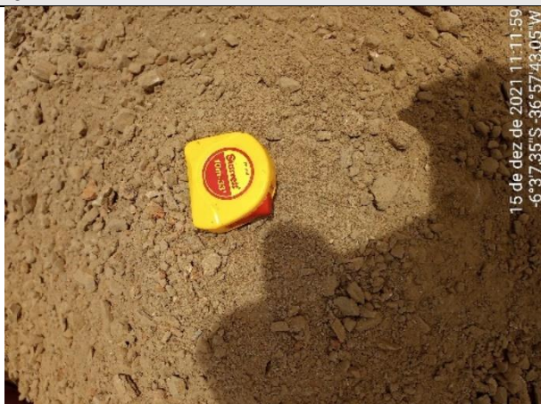
FOTO 11 – Material de 2ª categoria. Solo de alteração areno-argiloso, marrom, com fragmentos de rocha e rocha alterada mole. Atingiu 2,00 m de profundidade antes de alcançar o impenetrável, paralisando a esta profundidade.
