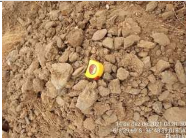
FOTO 22 – Material de 1ª categoria. Solo areno-argiloso, marrom, com cascalho e fragmentos de rocha. Espessura = 0,28 m.
