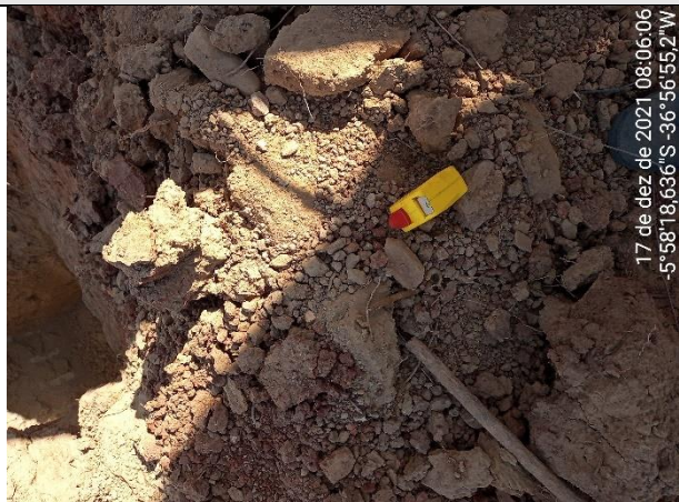
FOTO 46 – Material de 1ª categoria. Solo areno-argiloso, vermelho, com torrões. Espessura = 1,49 m.
