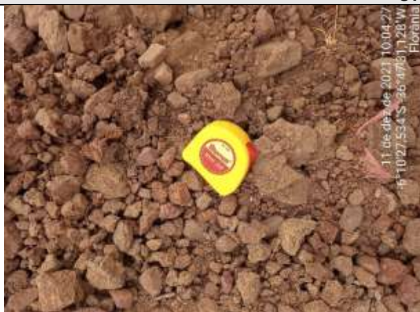
FOTO 18 – Material de 1ª categoria. Solo argiloso a argilo-siltoso, vermelho, com torrões. Espessura = 0,58 m.
