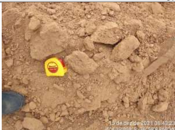
FOTO 44 – Material de 1ª categoria. Solo argiloso a argilo-siltoso, marrom claro, com torrões. Espessura = 0,62 m.
