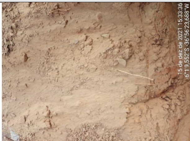
FOTO 24 – Material de 1ª categoria. Solo areno-argiloso, marrom, com fragmentos de rocha. Espessura = 0,90 m.
