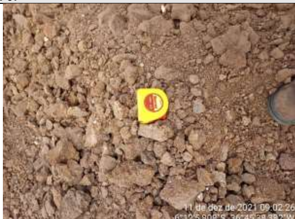
FOTO 13 – Material de 2ª categoria. Solo de alteração argilo-arenoso, marrom acinzentado, com fragmentos de rocha. Espessura = 0,28 m. Impenetrável aos 0,70 m.
