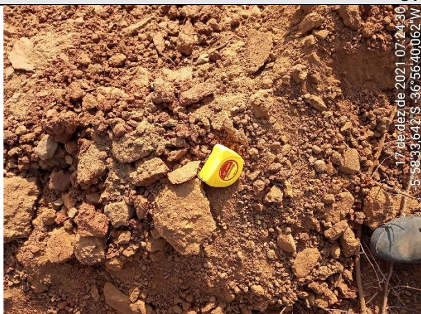
FOTO 42 – Material de 1ª categoria. Solo areno-argiloso, vermelho, com torrões. Espessura = 1,30 m.
