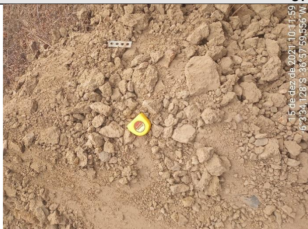
FOTO 06 – Material de 1ª categoria. Solo areno-siltoso, pouco argiloso, marrom claro, com torrões e fragmentos de rocha. Espessura = 0,55 m.
