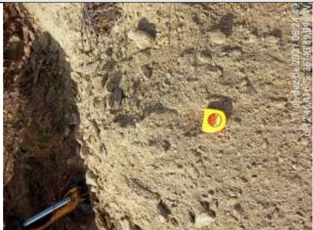
FOTO 09 – Material de 2ª categoria. Solo de alteração argilo-arenoso, marrom acinzentado, com fragmentos de rocha. Espessura = 1,40. Impenetrável aos 2,00 m.
