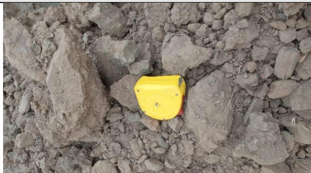
FOTO 31 – Material de 1ª categoria. Solo areno-argiloso, marrom, com torrões. Espessura = 1,20 m.
