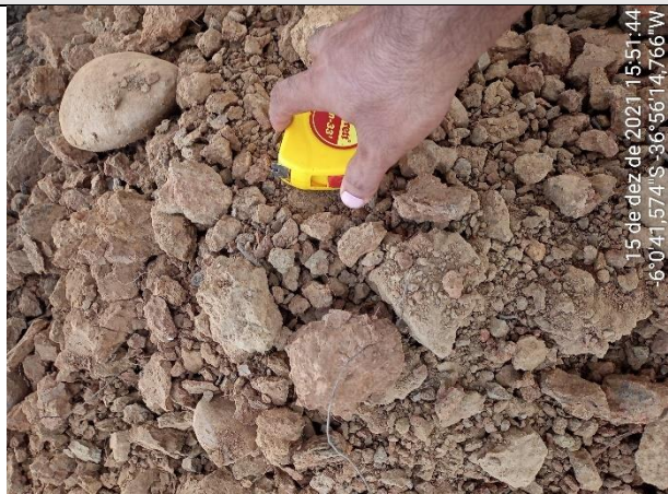
FOTO 26 – Material de 1ª categoria. Solo areno-argiloso, cinza esverdeado a avermelhado, com torrões. Espessura = 0,68 m.
