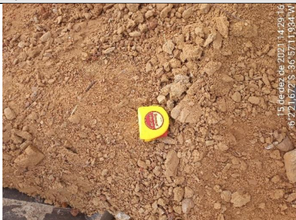
FOTO 17 – Material de 2ª categoria. Solo de alteração areno-argiloso, marrom, com fragmentos de rocha e rocha alterada mole na base. Espessura = 0,70 m. Impenetrável aos 1,60 m.
