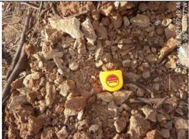
FOTO 07 – Material de 2ª categoria. Solo de alteração argilo-arenoso, marrom acinzentado, com fragmentos de rocha. Espessura = 0,20 m. Impenetrável aos 0,50 m.
