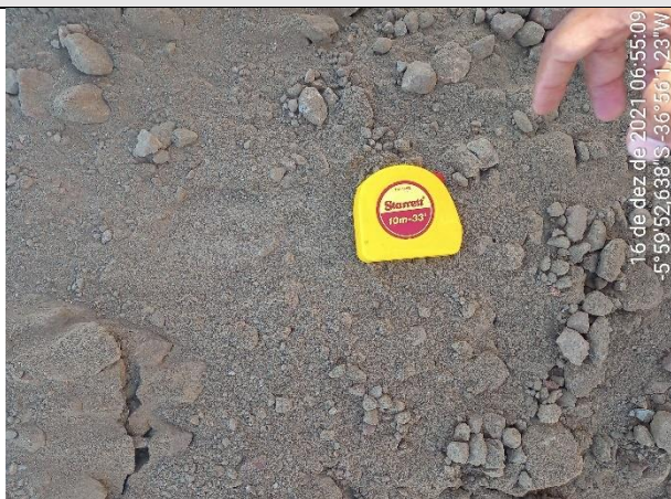
FOTO 34 – Material de 2ª categoria. Solo de alteração areno-argiloso, marrom acinzentado, com fragmentos de rocha e rocha alterada mole. Atingiu 2,00 m de profundidade antes de alcançar o impenetrável, paralisando a esta profundidade.
