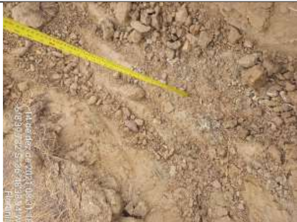
FOTO 23 – Material de 2ª categoria. Solo areno-argiloso, marrom, com cascalho e fragmentos de rocha, e rocha alterada mole na base. Espessura = 0,28 m. Impenetrável aos 0,56 m.
