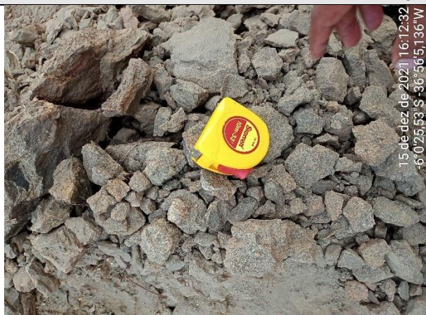
FOTO 29 – Material de 1ª categoria. Solo areno-argiloso, marrom, com torrões. Espessura = 0,65 m.
