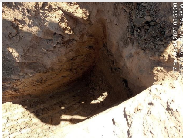
FOTO 50 – Material de 1ª categoria. Solo areno-argiloso, marrom, com torrões. Atingiu 2,00 m de profundidade antes de alcançar o impenetrável, paralisando a esta profundidade.
