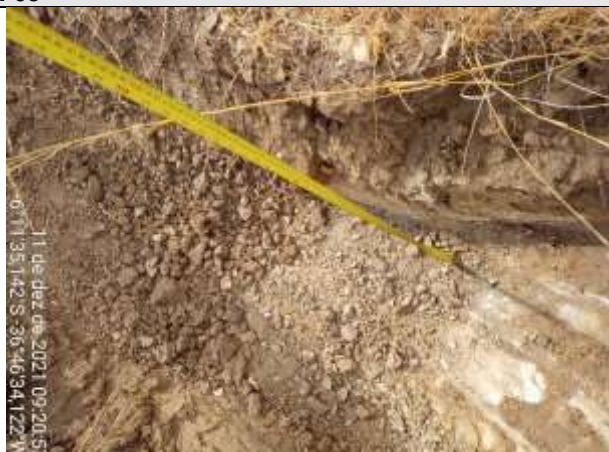
FOTO 15 – Material de 2ª categoria. Solo de alteração argilo-arenoso, marrom acinzentado, com fragmentos de rocha. Espessura = 0,42 m. Impenetrável aos 0,85 m.
