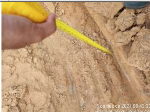
FOTO 45 – Material de 2ª categoria. Solo de alteração argilo-arenoso, marrom claro, com fragmentos de rocha e rocha alterada mole na base. Espessura = 0,28 m. Impenetrável aos 0,90 m.
