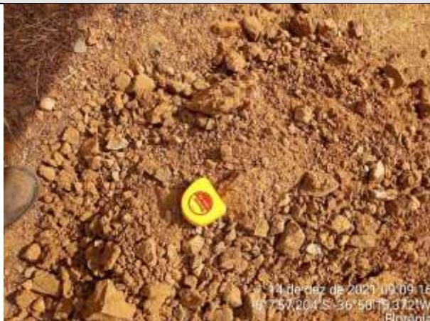
FOTO 26 – Material de 1ª categoria. Solo arenos-argiloso, vermelho claro, cascalhoso, com rocha na base. Espessura = 0,30 m. Impenetrável aos 0,30 m.
