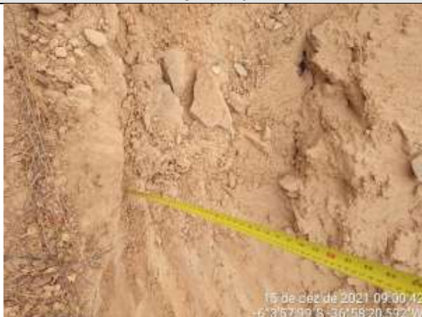
FOTO 46 – Sítio da ETA Jucurutu. Material de 1ª categoria. Solo argilo-arenoso, marrom claro, com fragmentos de rocha, e rocha alterada dura na base. Espessura = 0,90 m. Impenetrável aos 0,90 m.
