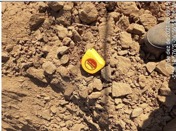
FOTO 47 – Material de 2ª categoria. Solo de alteração areno-argiloso, marrom, com fragmentos de rocha e rocha alterada mole. Atingiu 2,00 m de profundidade antes de alcançar o impenetrável, paralisando a esta profundidade.
