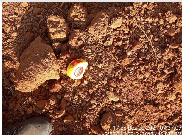
FOTO 44 – Material de 1ª categoria. Solo areno-argiloso, vermelho, com torrões. Espessura = 0,82 m.
