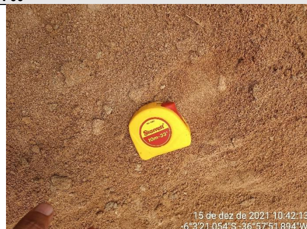
FOTO 09 – Material de 2ª categoria. Solo de alteração areno-argiloso, marrom, com fragmentos de rocha e rocha alterada mole na base. Atingiu 2,00 m de profundidade antes de alcançar o impenetrável, paralisando a esta profundidade.
