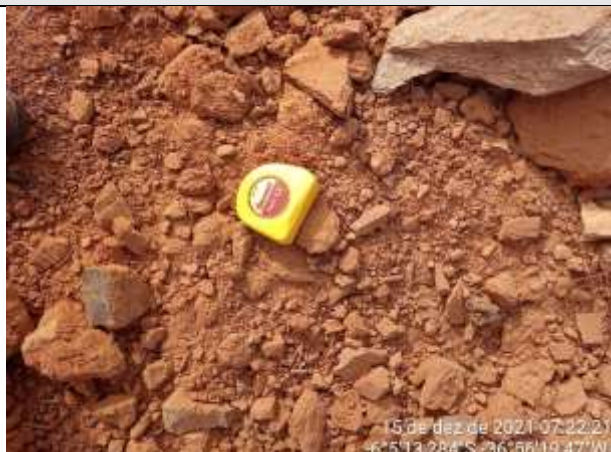
FOTO 37 – Material de 2ª categoria. Solo de alteração argilo-arenoso, marrom avermelhado, com fragmentos de rocha e rocha alterada dura na base. Espessura = 0,25 m. Impenetrável aos 0,60 m.
