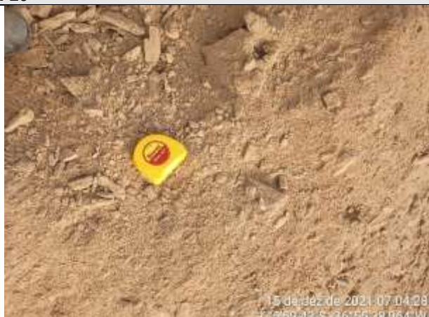
FOTO 35 - Material de 2ª categoria. Solo de alteração argilo-arenoso, marrom acinzentado, com fragmentos de rocha. Espessura = 0,80 m. Impenetrável aos 2,00 m.
