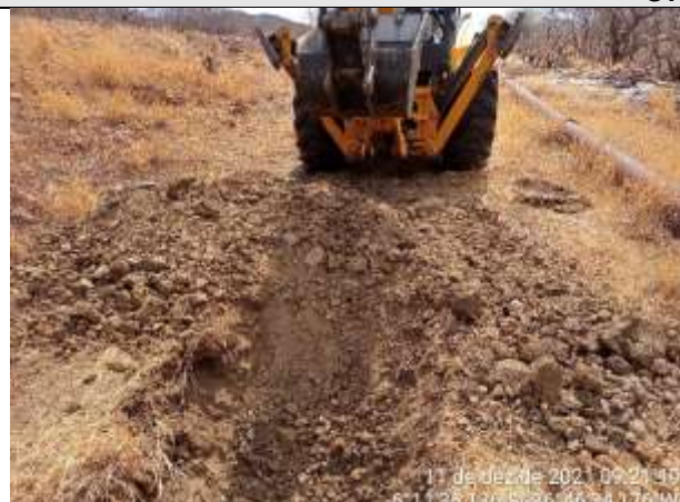
FOTO 14 – Material de 1ª categoria. Solo argilo-arenoso, marrom escuro, com cascalho. Espessura = 0,43 m.
