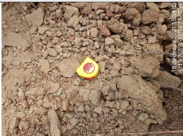
FOTO 25 – Material de 2ª categoria. Solo de alteração areno-argiloso, marrom, com fragmentos de rocha e rocha alterada mole na base. Espessura = 0,50 m. Impenetrável aos 1,40 m.
