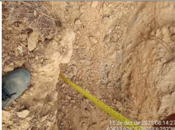
FOTO 41 – Material de 2ª categoria. Solo de alteração argilo-arenoso, marrom, com fragmentos de rocha e rocha alterada mole na base. Espessura = 0,25 m. Impenetrável aos 0,65 m.
