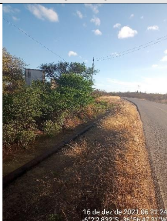
FOTO 21 – Sondagem não executada. Trecho com duas adutoras implantadas, mas apenas uma estava aparente. Risco de danificar a adutora enterrada.
