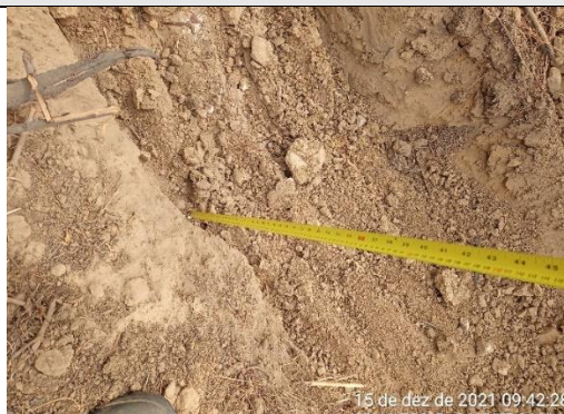
FOTO 04 – Material de 1ª categoria. Solo areno-argiloso a argilo-arenoso, marrom escuro, com torrões e rocha alterada mole na base. Espessura = 0,65 m. Impenetrável aos 0,65 m.
