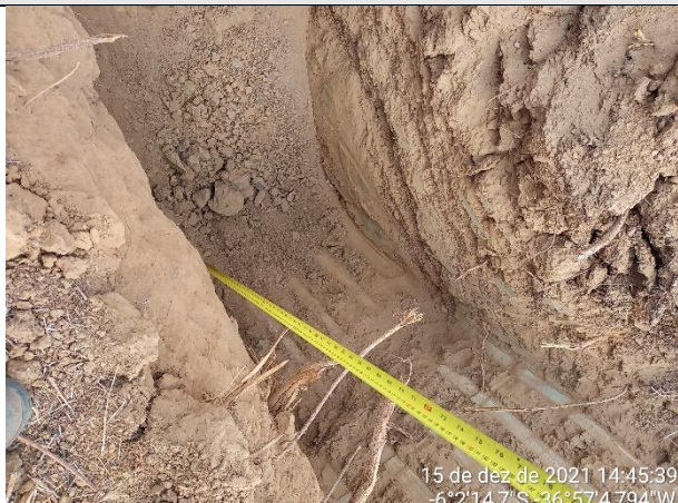
FOTO 19 – Material de 2ª categoria. Solo de alteração areno-argiloso, marrom, com fragmentos de rocha. Espessura = 0,60 m. Impenetrável aos 1,70 m.
