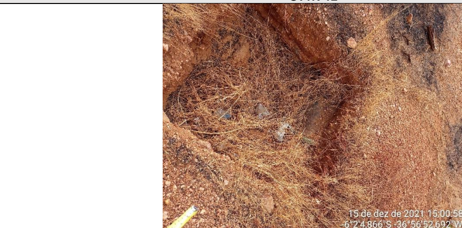
FOTO 20 – Material de 1ª categoria. Solo areno-argiloso, cascalhoso, marrom escuro a avermelhado. Espessura = 0,60 m. Impenetrável aos 0,60 m. OBS.: Ponto coincidiu com sondagem executada no projeto básico.
