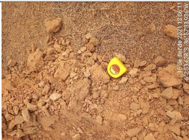
FOTO 12 – Material de 1ª categoria. Solo areno-argiloso, marrom avermelhado, com torrões e fragmentos de rocha. Espessura = 0,50 m.
