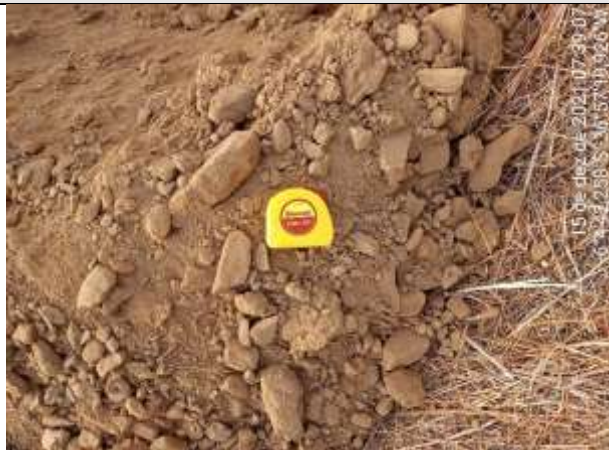
FOTO 38 – Material de 1ª categoria. Solo silto-argiloso, marrom, com fragmentos de rocha. Espessura = 0,72 m.
