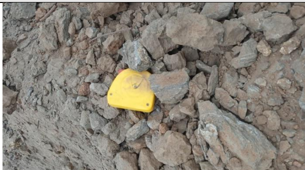
FOTO 32 - Material de 2ª categoria. Solo de alteração areno-argiloso, marrom, com fragmentos de rocha e rocha alterada mole. Atingiu 2,00 m de profundidade antes de alcançar o impenetrável, paralisando a esta profundidade.
