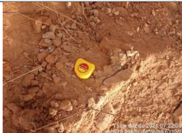
FOTO 36 – Material de 1ª categoria. Solo argiloso a argilo-siltoso, marrom claro, cascalhoso. Espessura = 0,35 m.
