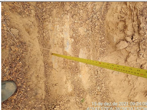
FOTO 03 – Material de 2 categoria. Solo de alteração areno-argiloso, marrom, com fragmentos de rocha e rocha alterada mole na base. Espessura = 0,25 m. Impenetrável aos 0,60 m.
