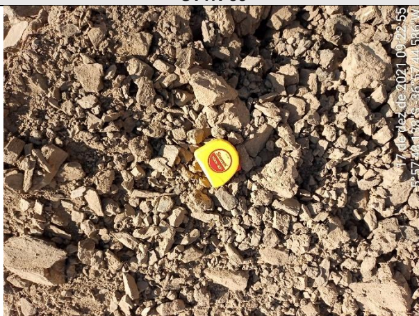
FOTO 52 – Material de 1ª categoria. Solo areno-argiloso, marrom acinzentado, com torrões. Espessura = 1,10 m. Impenetrável aos 1,10 m.
