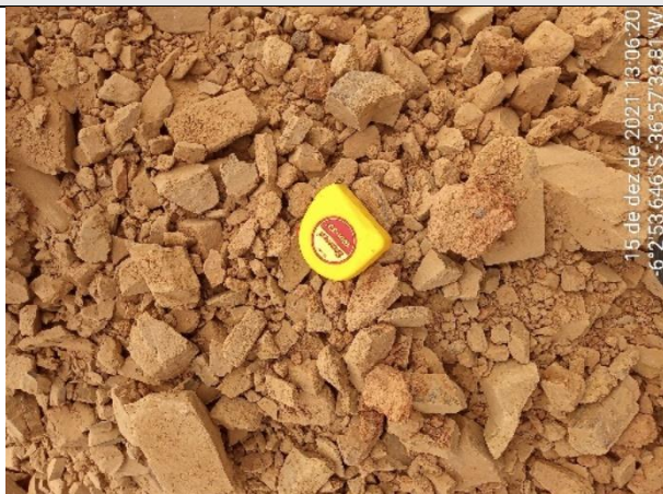
FOTO 13 – Material de 2ª categoria. Solo de alteração areno-argiloso, marrom avermelhado, com fragmentos de rocha e rocha alterada mole na base. Espessura = 0,20 m. Impenetrável aos 0,70 m.
