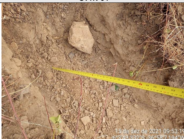
FOTO 05 – Material de 1ª categoria. Solo areno-argiloso, marrom, com fragmentos de rocha e rocha alterada mole na base. Espessura = 0,60 m. Impenetrável aos 0,60 m.
