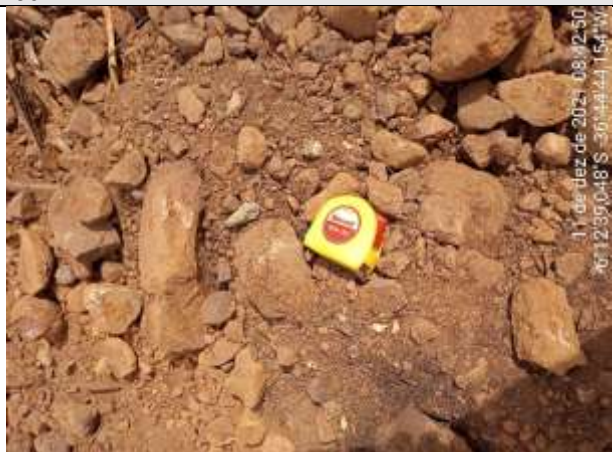
FOTO 11 – Material de 2ª categoria. Material argilo-arenoso, vermelho, com fragmentos de rocha e rocha alterada mole na base. Espessura = 0,30 m. Impenetrável aos 0,60 m.
