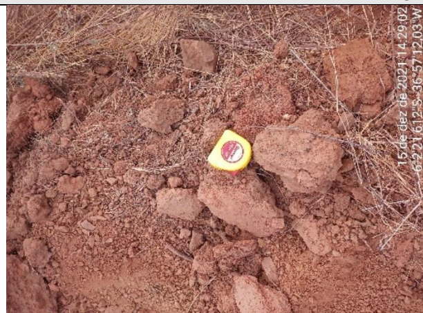
FOTO 16 – Material de 1ª categoria. Solo areno-argiloso, avermelhado, com torrões. Espessura = 0,90 m.
