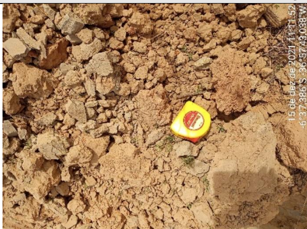
FOTO 10 – Material de 1ª categoria. Solo areno-argiloso, marrom, com torrões. Espessura = 1,40 m.
