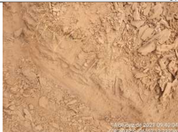
FOTO 28 – Material de 1ª categoria. Solo areno-argiloso, pouco siltoso, marrom claro, com fragmentos de rocha. Espessura = 0,40 m.
