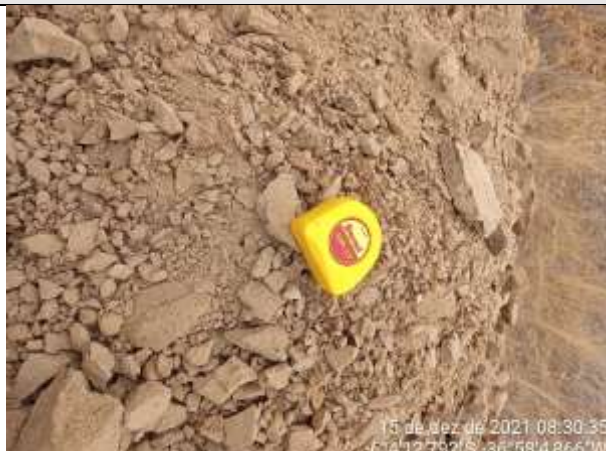
FOTO 43 – Material de 2ª categoria. Solo de alteração argilo-arenoso, marrom claro, com fragmentos de rocha e rocha alterada mole na base. Espessura = 0,50 m. Impenetrável aos 1,10 m.
