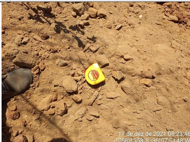
FOTO 49 – Material de 2ª categoria. Solo de alteração areno-argiloso, marrom, com fragmentos de rocha e rocha alterada mole na base. Espessura = 0,60 m. Impenetrável aos 1,50 m.
