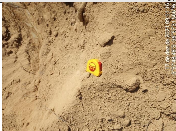
FOTO 51 – Material de 1ª categoria. Solo areno-argiloso, pouco siltoso, marrom amarelado, com fragmentos de rocha e rocha alterada mole na base. Espessura = 0,90 m. Impenetrável aos 0,90 m. OBS.: Em um raio de 50 metros existem diversos afloramentos rochosos.
